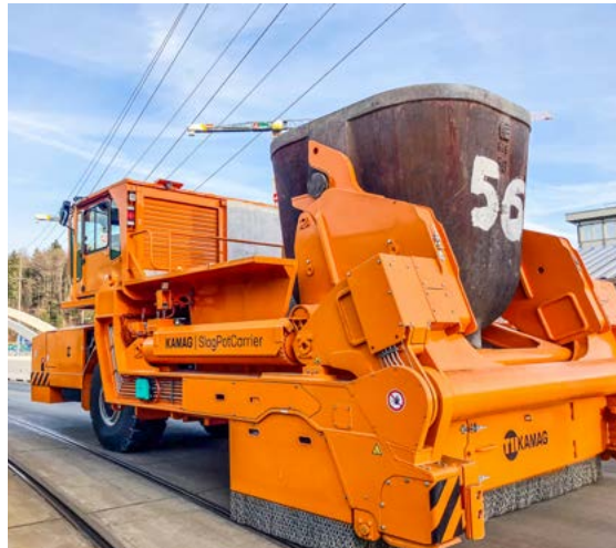
New slag pot carrier, Emmenbrücke
