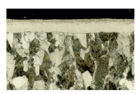
ETG® 100, 520 °C 10h, K<sub>N</sub> = 2, 硝酸浸蚀剂
