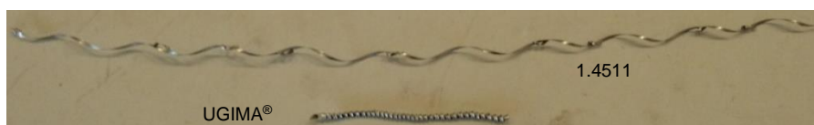
Copeaux obtenus en perçage avec foret à embout ISCAR IC908 Ø9,9mm – ICM099 à V c = 90 m/min et f = 0,1 mm/tr
