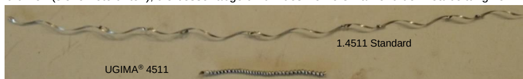
Späne beim Bohren mit Bohraufsatz ISCAR IC908 Ø9,9mm – ICM099 bei V_c = 90 m/min und f = 0,1 mm/U
