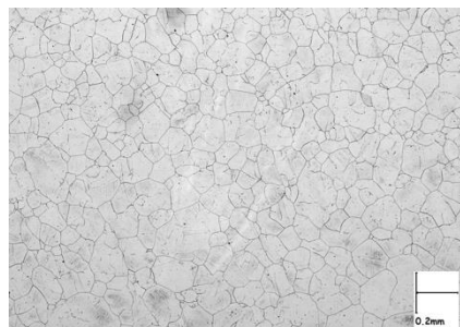
Mikrogefüge in Querrichtung für Ø 20 mm
