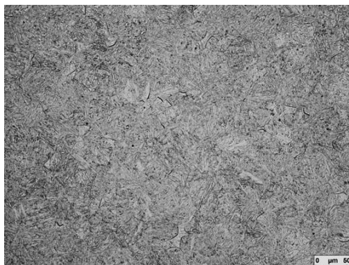
Microstructure de l' UGIDRILL 13 à l'état trempé + revenu
