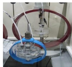
Standardkorrosionszelle zur Bestimmung der Spannungsrißkorrosion
