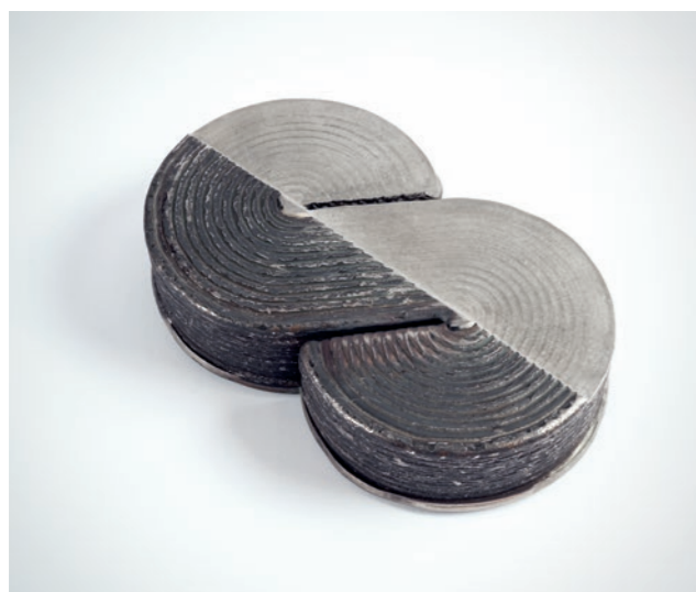
Logo Swiss Steel en UGIWAM 316LSi réalisé par Axive Additive
