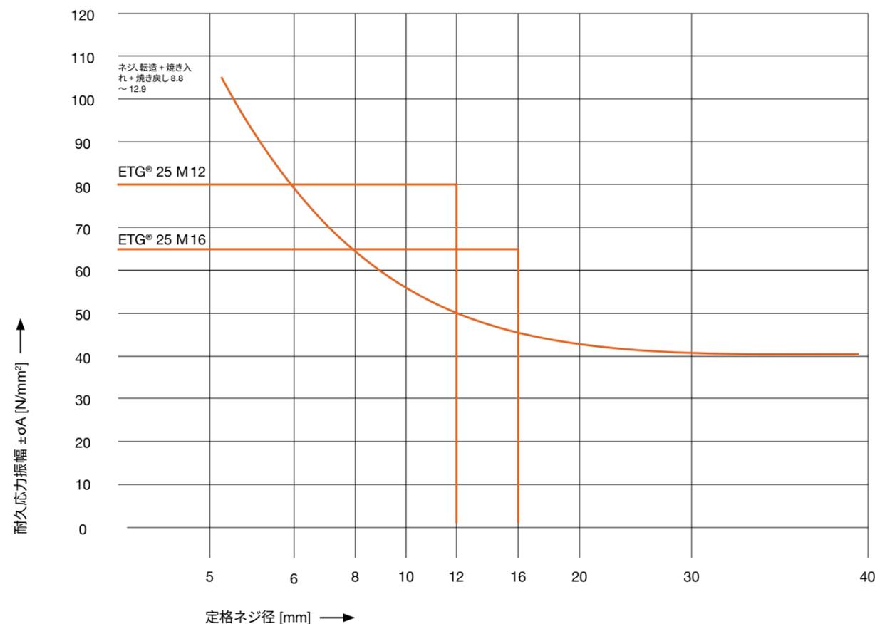
ETG<sup>®</sup> 25 ネジ切りボルト (転造ネジ) の静的応力。EN ISO 898-1 準拠のネジ棒試験。応力断面で表した強度値。
